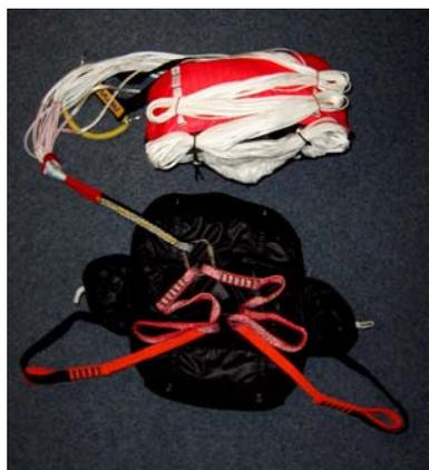
Velcroter les élévateurs au fond du conteneur et disposer les éléments de connexion puis le POD par-dessus.
