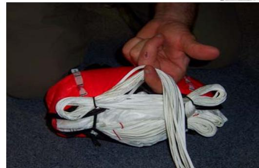
Verrouiller le deuxième élastique du POD avec une autre boucle de suspente.
