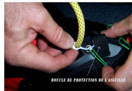
Placer les aiguilles du centre vers l'extérieur du conteneur en les glissant dans le loop correspondant puis dans le fourreau de protection.
