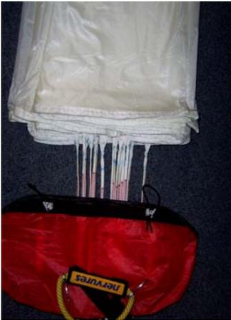
Placer le POD sur le secours afin de contrôler la bonne largeur du pliage. La largeur de la bande de tissus doit être environ 4 à 5 cm inférieure à celle du pod.
