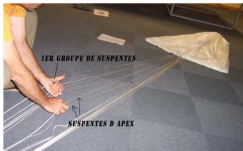
Démêler les suspentes et les suspentes d'apex.
