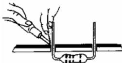
2- Les joints de soudure doivent briller et doivent être coniques en forme.
