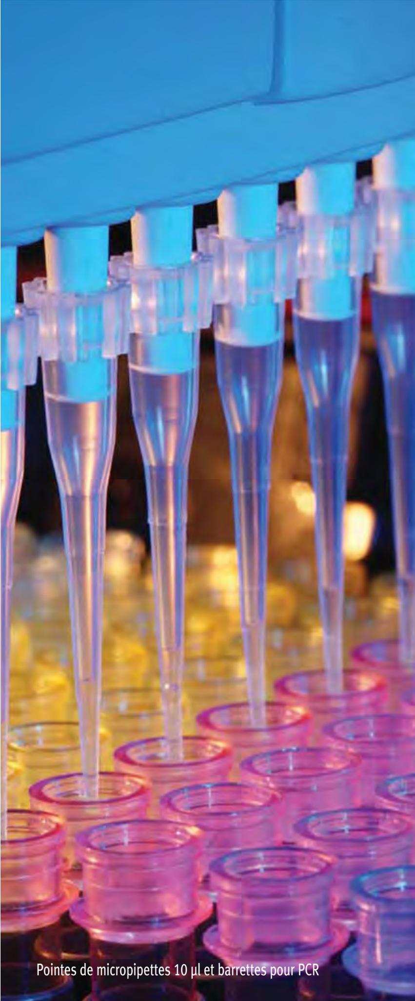
Pointes de micropipettes 10 µl et barrettes pour PCR
