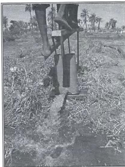
**Utilisation recommandée :** Cette pompe est recommandée là où le jardin est situé plus haut que la pompe ou sur les sites où encore il y a une autre raison de s'approvisionner de l'eau sous-pression (comme les zones sablonneuses). Elle peut être connecté à un réseau d'irrigation en tuyau PVC enterré. Cette pompe est capable de pousser l'eau à une hauteur verticale de 7 m (ex. remplissage d'un chateau d'eau).
