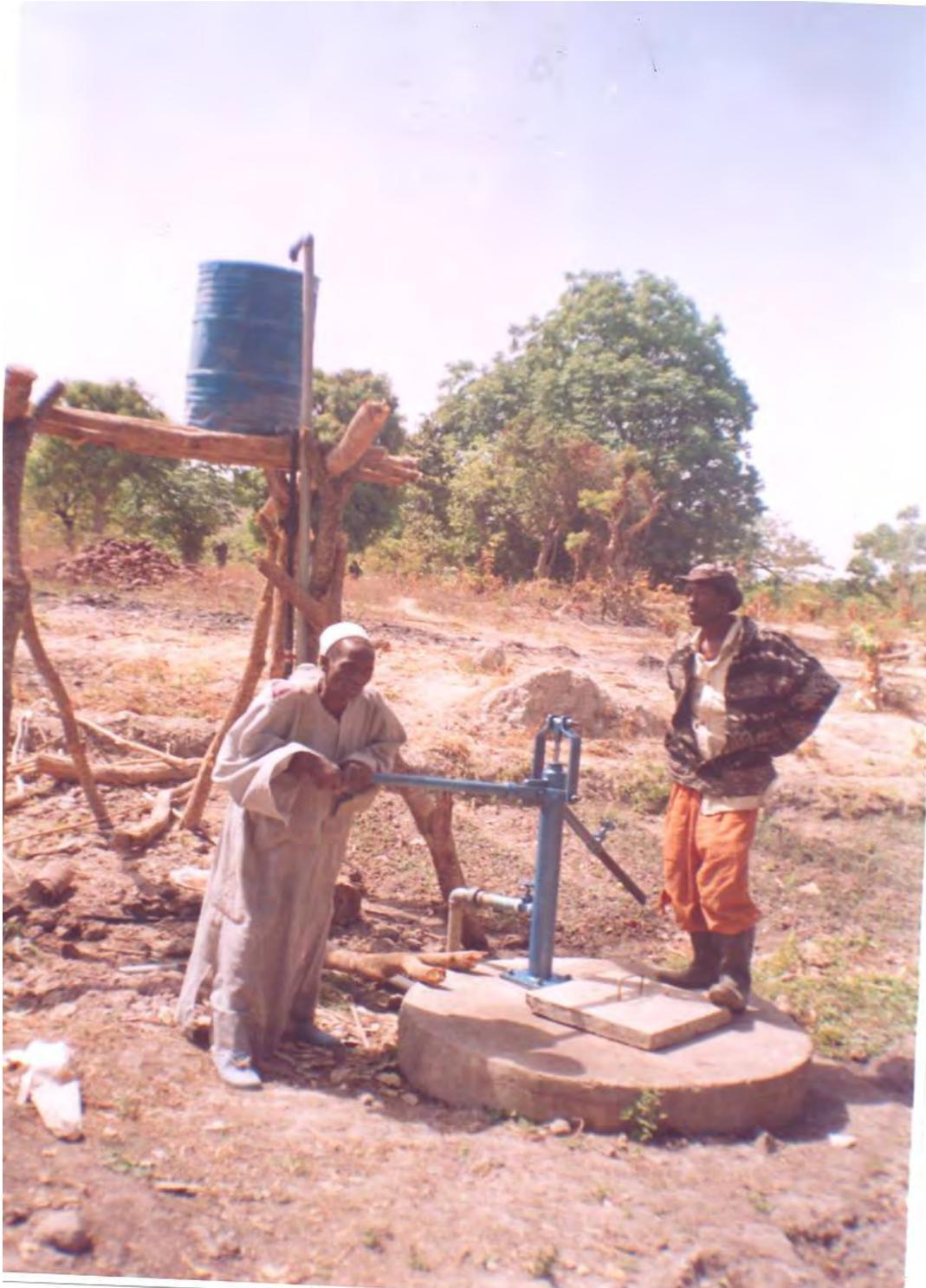
Source : Photo prise par les services du génie rural de Labé montrant un exemple d'essai de remplissage d'un fut sur mirador pour servir de réservoir associé au système d'irrigation en milieu paysan par la pompe à motricité humaine fabriquée en Moyenne Guinée par l'entreprise privée FAPEL basée à Labé.
