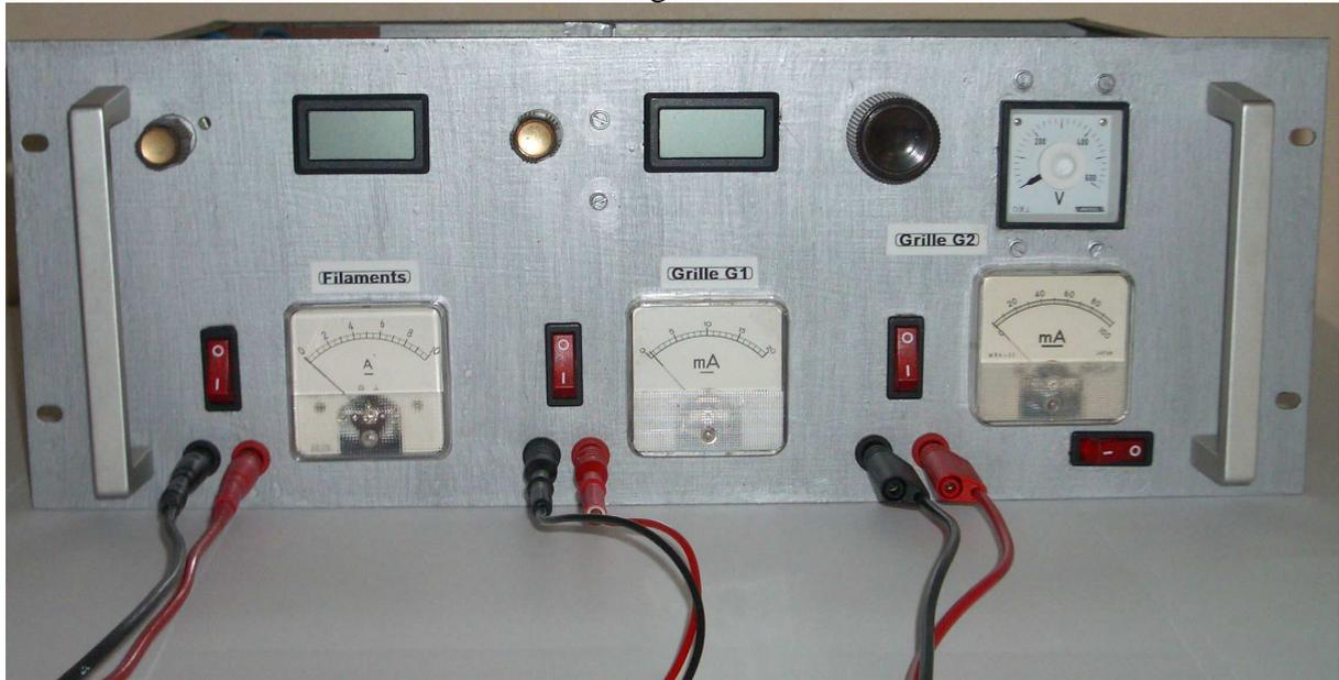
Photo n° 4 : le chassis qui supporte le GU74B à reconditionner et à tester.
