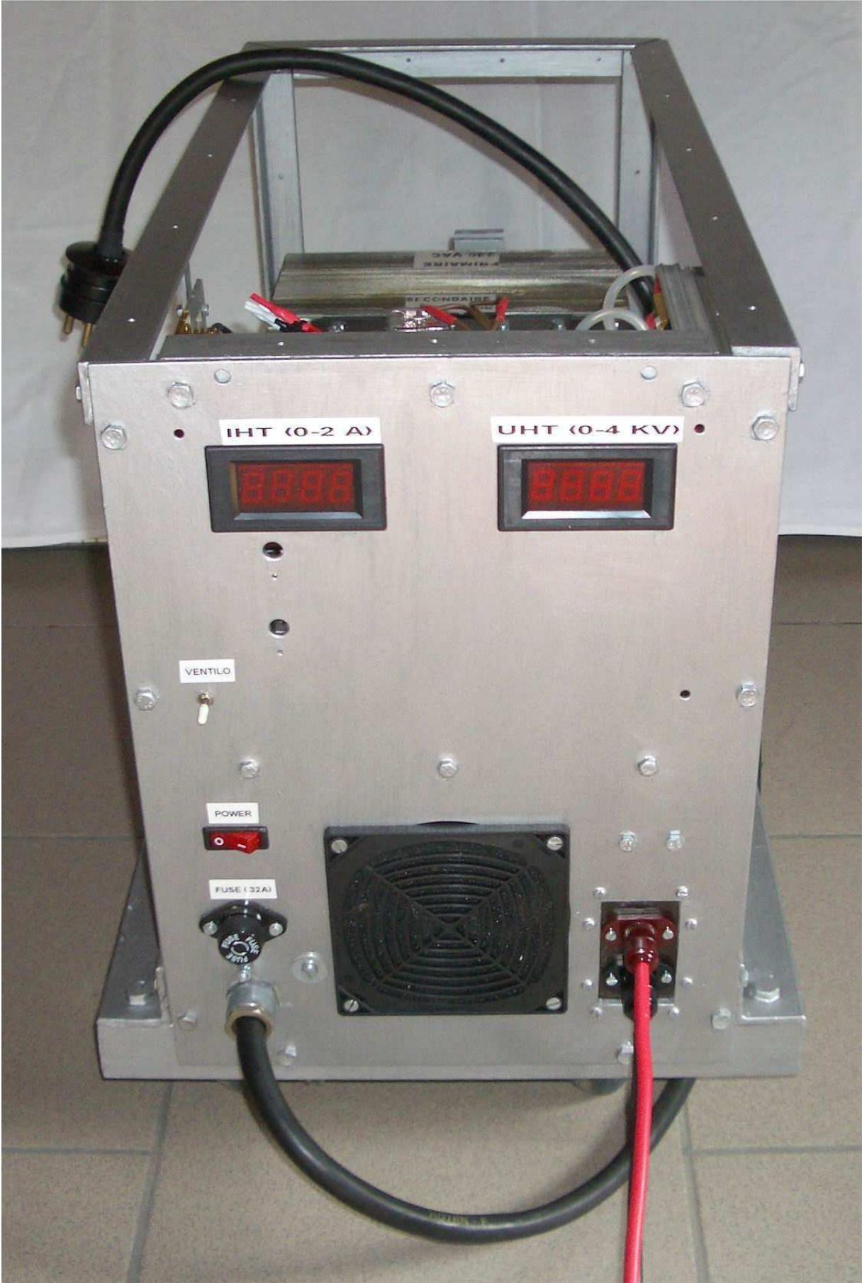
Photo n° 3 : l'alimentation du filament et des grilles G1 et G2.
