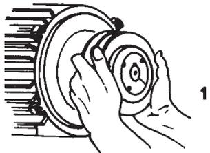
Mettez en place la poulie et son moyeu sur l'arbre, alignez-les et serrez les vis imbus régulièrement et à fond.
