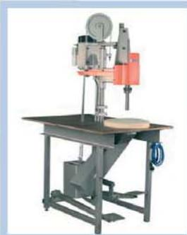
chose pour faciliter nettement le travail des opérateurs. La perceuse à hosties entraînée auparavant avec une pédale peut être maintenant équipée pour l'entraînement pneumatique!
