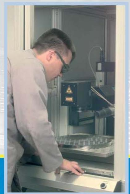
Les plaques de cuisson sont gravées automatiquement et avec une haute précision sur la machine à graver au laser
