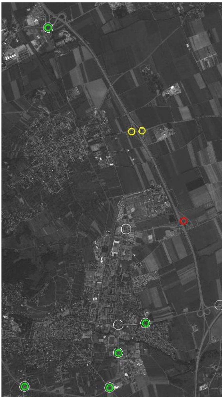
FIG. 7.5 – Les ronds-points détectés sur l'image satellitaire utilisée pour le test. (cercle blanc : objets répertoriés, cercle vert : bonne détection, cercle rouge : mauvaise détection, cercle jaune : bonne détection, mais l'objet n'est pas répertorié.
