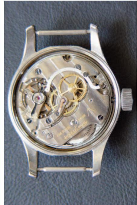
Die beiden in der Mk. 11 eingesetzten Kaliber: IWC Kal. 89 und Jaeger-LeCoultre Kal. 488/Sbr. Gut zu erkennen das völlig unterschiedliche Werk-Layout sowie die Stoßsicherung der IWC, während eine solche bei der JLC fehlt
