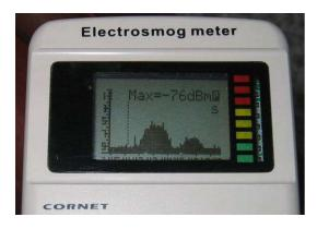
Exemple d'affichage en mode analyseur de spectre Wifi. Ici on est en mode affichage par fréquences (on peut aussi demander par canal) et en cumulatif (on peut aussi afficher les variations en temps réel) ce qui est pratique pour évaluer l'exposition maxi (on peut le laisser enregistrer sur la durée). En effet les cartes wifi des PC n'émettent pas en permanence et la puissance est variable.
