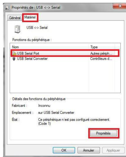
**10<sup>ème</sup> étape :** Sélectionnez l'onglet '**Matériel**', sélectionnez USB Serial port qui pose problème (signalé par un panneau d'avertissement jaune) à puis cliquez sur '**Propriétés**'.
