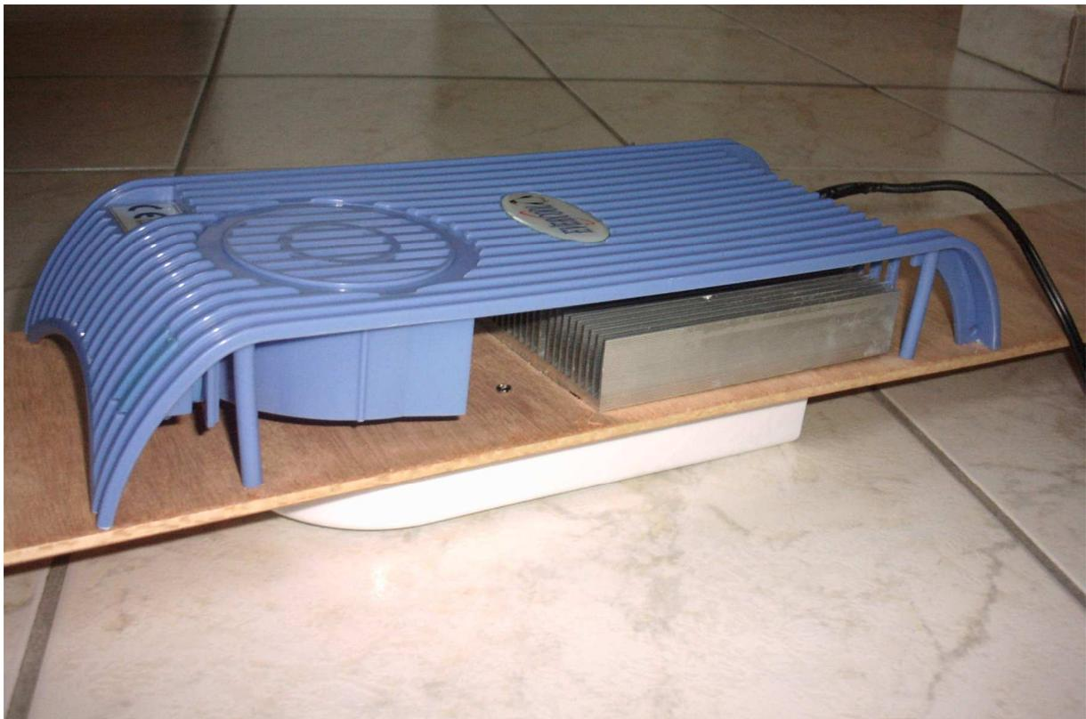
Néanmoins, le démontage de la glacière nous fournit un capot totalement ouvert. J'ai donc utilisé une fine plaque de polystyrène servant initialement aux modèles réduits. De cette manière, le capot est totalement fermé et il ne reste que les trous d'aération initiaux :
