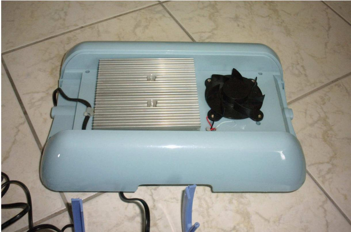
Dans le capot intérieur on peut aussi distinguer un radiateur et un ventilateur qui, eux aussi, seront récupérés pour mon montage :
