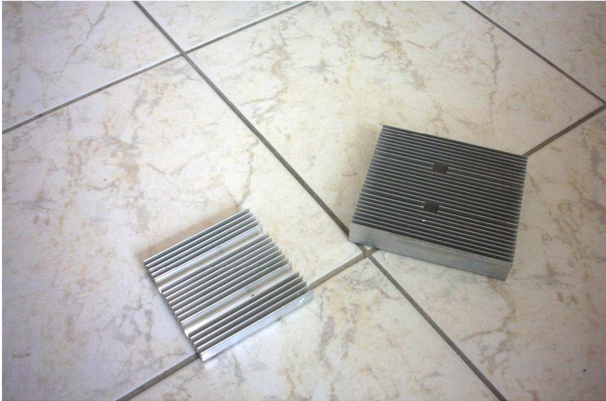
Les trous d'origine permettent d'ailleurs de solidariser les deux radiateurs :
