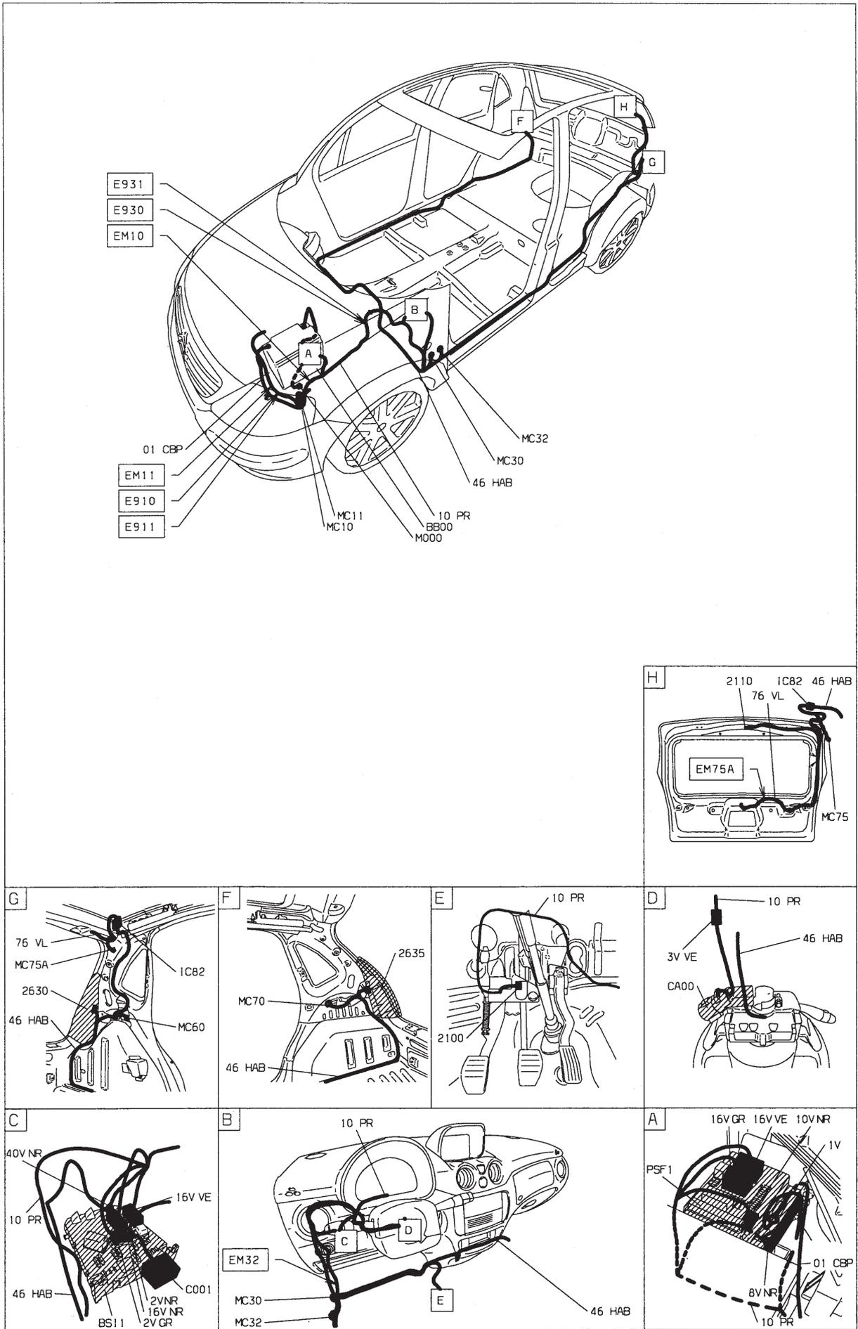
Feux stop TU5JP4 (NFU) - boîte de vitesses manuelle pilotée - avec contrôle de stabilité
