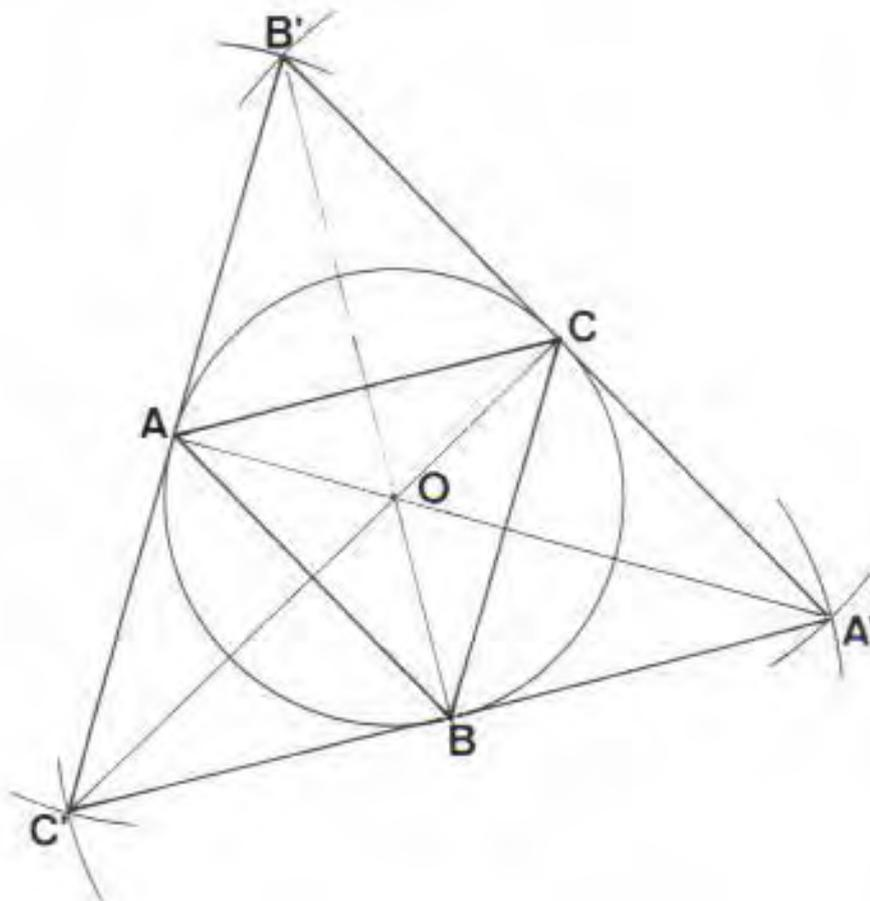
ABC étant un triangle équilatéral, il en est de même des trois triangles  $BA'C$ ,  $CB'A$  et  $AC'B$ , symétriques du triangle ABC respectivement par rapport aux droites (BC), (AC) et (AB). Les six segments  $[BA']$ ,  $[A'C]$ ,  $[CB']$ ,  $[B'A]$ ,  $[AC']$  et  $[C'B]$  sont tous isométriques à  $[AB]$ .
