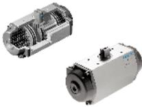
Les entraînements pneumatiques à fraction de tour sont compacts, à l'épreuve des surcharges et atteignent un couple élevé. L'angle de rotation peut généralement être réglé entre 0 et 180 degrés.
