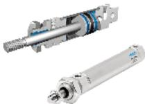
Pour des raisons de sécurité de retour, on utilise aujourd'hui principalement des vérins à double effet. Leur utilisation est impérative lorsqu'un travail doit être effectué dans les deux sens.
