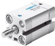
Le vérin possède un raccord ainsi qu'un orifice de mise à l'atmosphère côté tige. Cet orifice doit être protégé de l'encrassement afin que la course du piston ne soit pas gênée par l'accumulation d'air. C'est pourquoi un filtre est généralement placé sur la sortie de mise à l'atmosphère.
