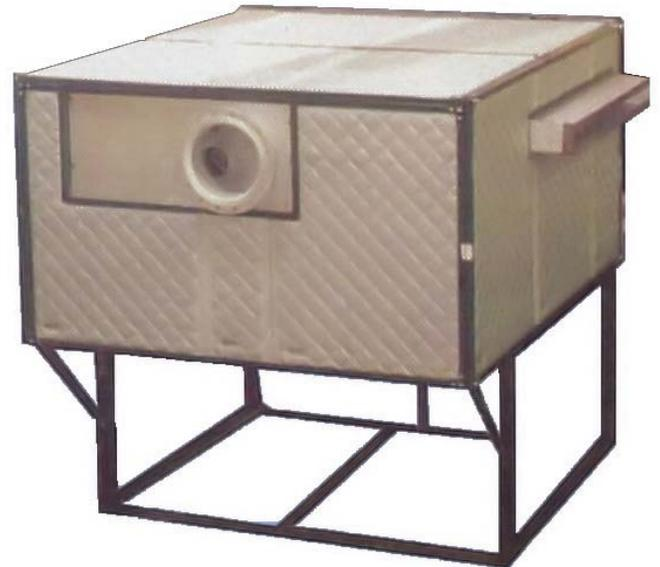
**Table de support pour collecteur horizontal** dotée de quatre (4) jeux d'embase en « V » à 30° de 6 pouces (152 mm) de diamètre avec fentes réglables, rouleaux de protection recouverts de terpolymère éthylène-propylène-diène à l'entrée et à la sortie du collecteur (non illustrés) et boîte de répartition de l'air. Cette unité sert à sécher l'acier en bandes après la phase de nettoyage à 968 pieds/min. (295 m/min.), largeur de bande de 49 pouces (1 245 mm).
