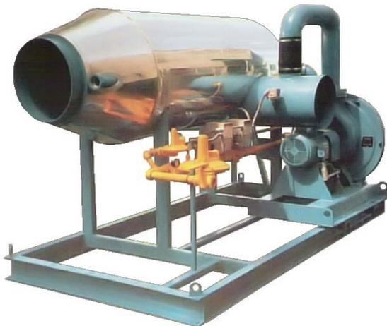
**Table de support pour collecteur horizontal** avec boîtier d'insonorisation. Le boîtier d'insonorisation comprend un collecteur et un ventilateur servant à éliminer l'air chaud et humide du boîtier. Pour cette unité, les tests sonores réalisés sur le terrain ont donné des résultats inférieurs à 85 décibels.
