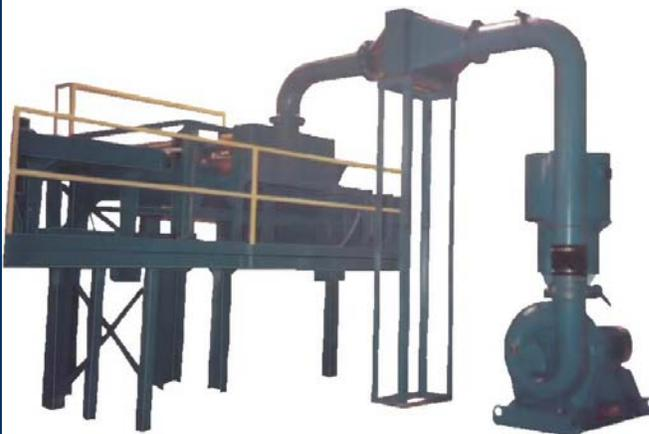
**Structure de support pour collecteur vertical** dotée de quatre (3) jeux d'embases en « V » à 15° de 6 pouces (152mm) de diamètre avec fentes réglables, rouleaux de protection recouverts de terpolymère éthylène-propylène-diène à l'entrée et à la sortie du collecteur et boîte de répartition de l'air. Cette unité sert à sécher l'acier en bandes après la trempe à 600 pieds/min. (182 m/min.), largeur de bande de 49 pouces (1 245mm).
