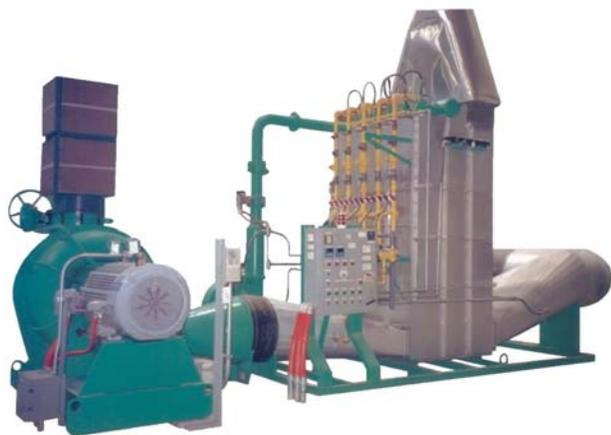
**Système de séchage des bandes** avec réchauffeur à vapeur sur une chaîne de décapage de type push-pull. Ce système est conçu pour sécher des bandes de 72 pouces (1 830 mm) de large à une vitesse maximale de 500 pieds/min. (152 m/min.).
