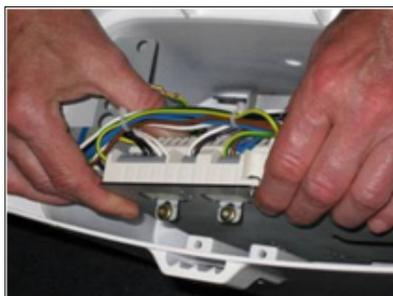
2. Le fait de retirer la plaque de montage permet d'accéder aux composants et au câblage.
