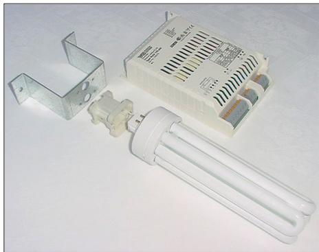
Une ampoule fluorescente 70 Watt à lumière blanche (code couleur 830) constitue la source de lumière première du luminaire. L'intensité de lumière de cette source de lumière première peut être réglée progressivement, en allant de la puissance maximale de 100 % à la puissance minimale de 3%. Ainsi, l'intensité de lumière de cette source de lumière peut être adaptée en fonction des besoins.
